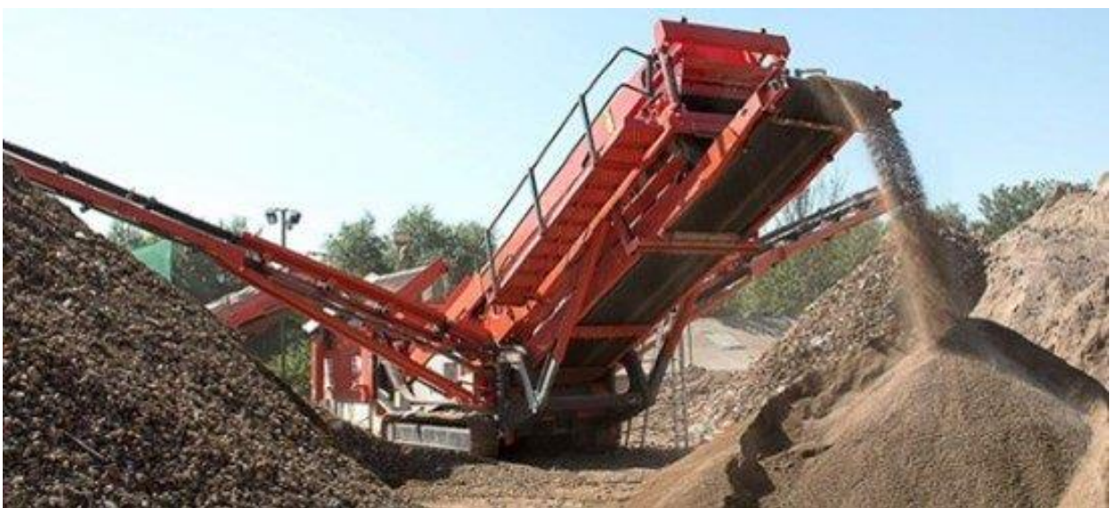
Crible mobile séparant les fractions sableuses et granulaires
