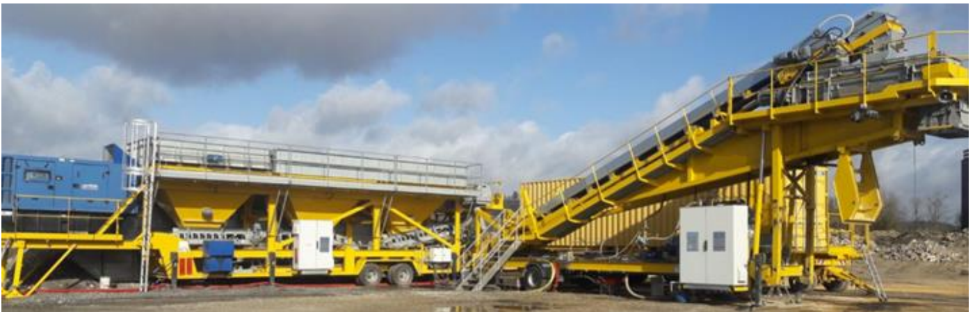
Centrale mobile de malaxage et d'enrobage à froid
