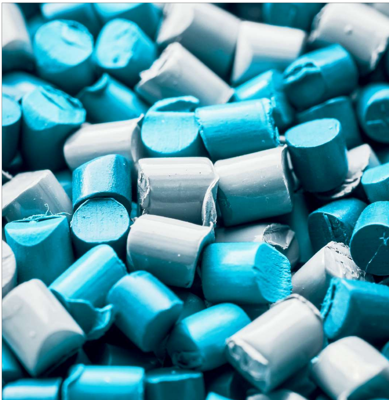
Granulés de polypropylène (PP) avant leur fonte pour produire des objets plastiques / Maciej Bledowski / AdobeStock
